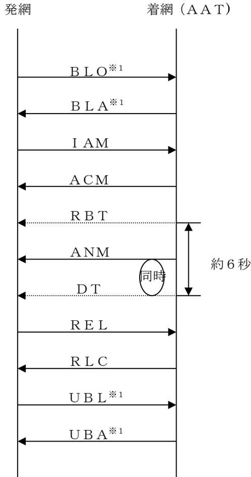
※1：発網側で閉塞して試験を行う場合はBLOを送信する。着信側で閉塞されている場合は発網側からの試験は不可とする。閉塞して試験を行った場合は、試験終了後UBLを送信し閉塞を解除する。
